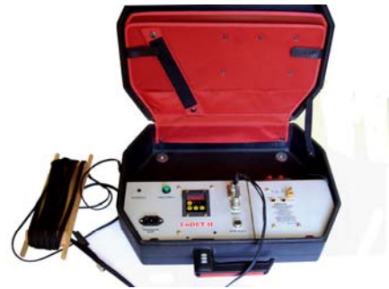
Уређај за мерење брзине детонације и времена успорења средстава за иницирање
